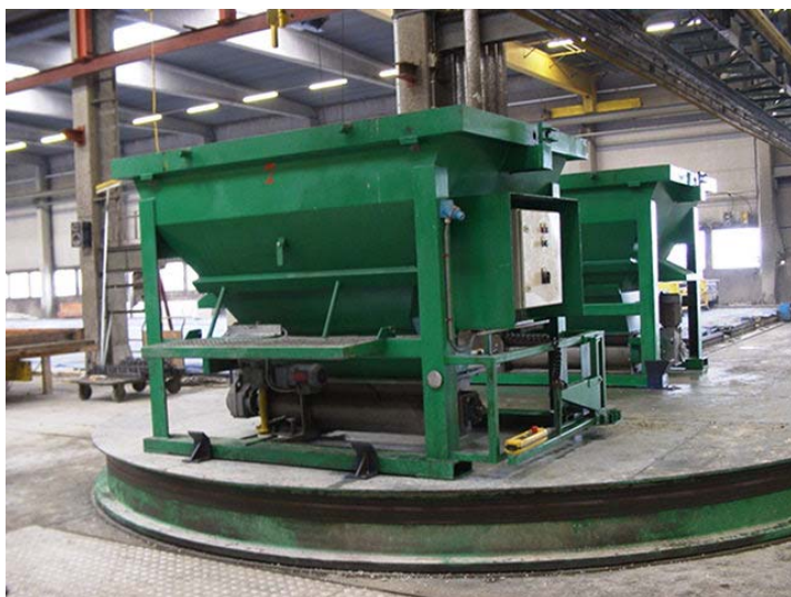
Obr. 12.1 Použitie zásobníka/násypky so šnekom na aktiváciu SZB tesne pred jeho ukladaním
