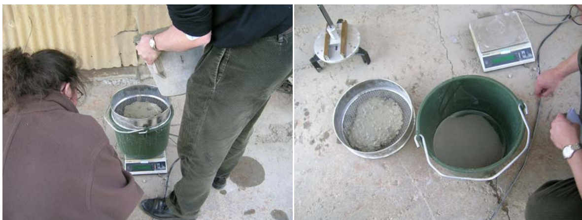
Obr. 8.4 Sitová skúška odolnosti voči segregácii
