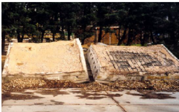
Obrázok 15: Vzorky po skúške na požiarnu odolnosť podľa (iv) . Naľavo je vzorka s mikrovlákňami, napravo vzorka bez vlákien
