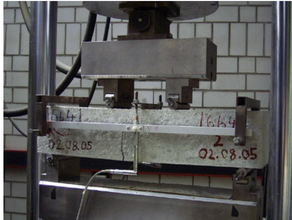
Obrázok 4: Skúška so štyrmi zaťažovacími bodmi na hranole pre stanovenie diagramu deformácie od zaťaženia (fotografia so zvolením spoločnosti „Krampe Harex“)
