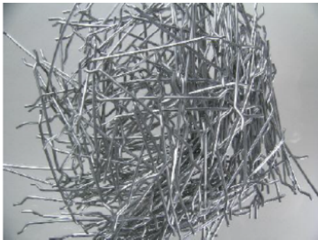
Obrázok 5: Za studena ťahaný drôt (Stahdrahtfaser)
